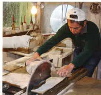
切り出した原石を成形して砥石に仕上げる
