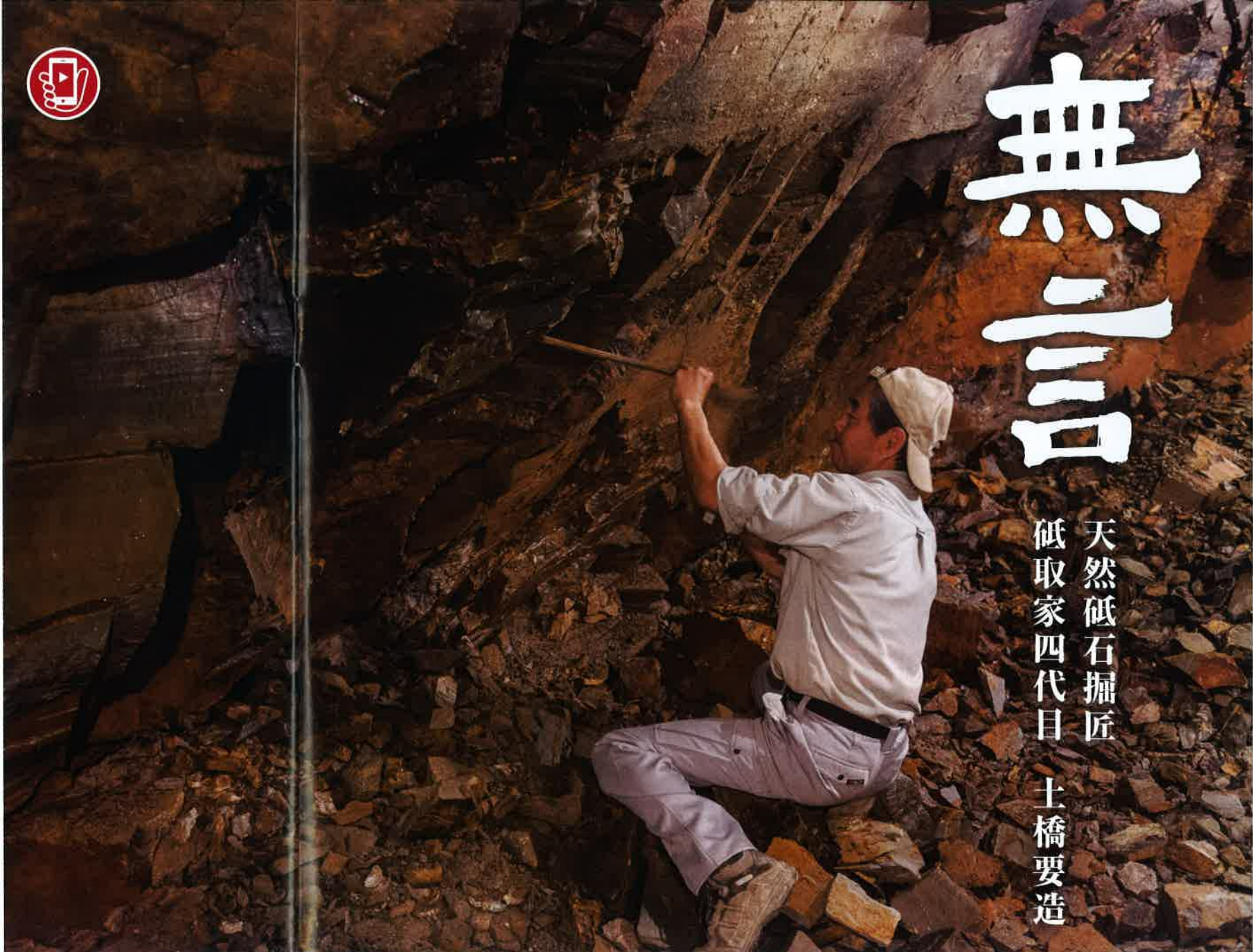
▲亀岡市北西部、丸尾山の山中に掘られた採掘場。長年の経験をもとに地層の違いを見極め、上質な砥石層を掘り当てていく。火薬による発破もあるが、基本的には地道な手作業
