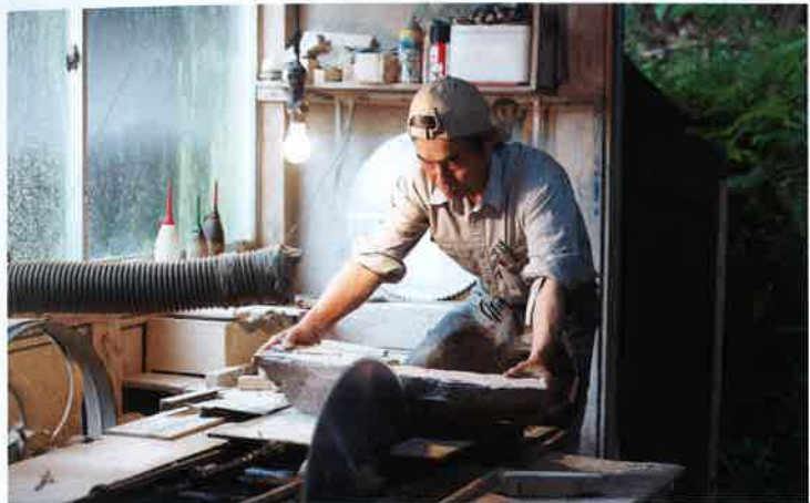
▶おおよそのサイズと形に切り出した砥石は、水平を保った回転盤に当てて表面を研磨。この後、手作業による仕上げの研磨を経て、天然砥石が完成する。同じものは一つもない文字通りの一点ものだ
