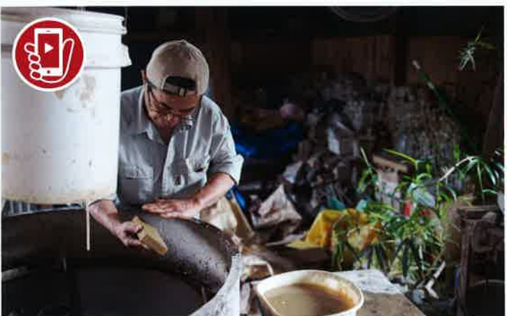
▶おおよそのサイズと形に切り出した砥石は、水平を保った回転盤に当てて表面を研磨。この後、手作業による仕上げの研磨を経て、天然砥石が完成する。同じものは一つもない文字通りの一点ものだ
