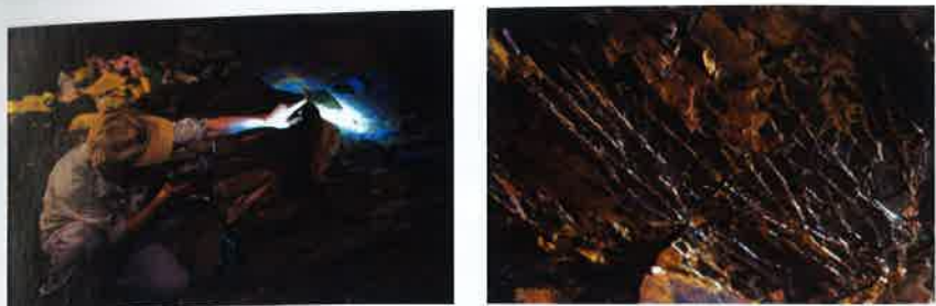
▲亀岡市北西部、丸尾山の山中に掘られた採掘場。長年の経験をもとに地層の違いを見極め、上質な砥石層を掘り当てていく。火薬による発破もあるが、基本的には地道な手作業
